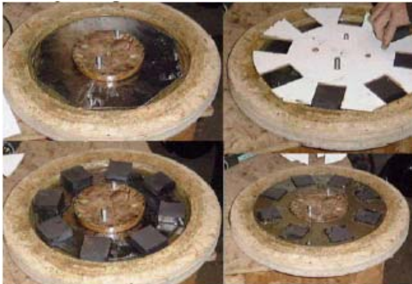
Patru etape ale procedurii de turnare a rotorului
