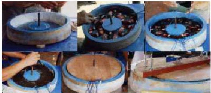
Șase etape ale procedurii de turnare a statorului
