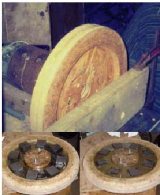
Realizarea matriței rotorului și utilizarea sa
